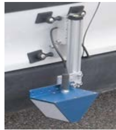
Các cảm biến đo tốc độ xe (nguyên tắc radar)
