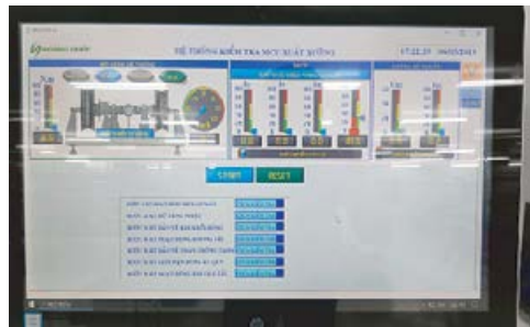
Hệ SCADA thu thập dữ liệu từ neo, máy lái.
