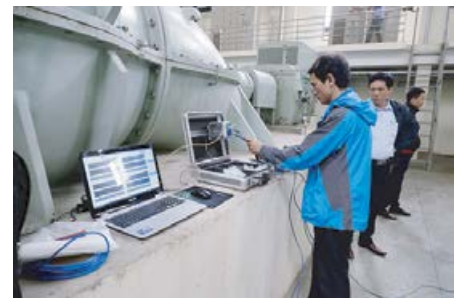
Đo rung động giám sát máy móc, kết cấu (Giám sát dựa trên tình trạng - CBM và Bảo trì qua chẩn đoán sớm - PdM)
